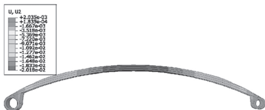
图5 载荷950 N时复合材料板簧Y方向变形图
