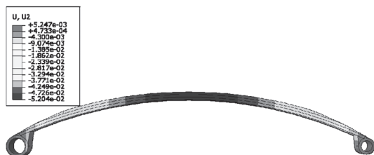
图6 载荷2450 N时复合材料板簧Y方向变形图
